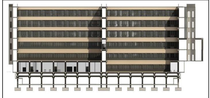
Corte transversal y aislación sísmica
