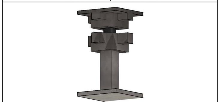
Sistema de aislación sísmica.
