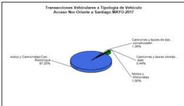
Gráfico 2: Distribución de Flujos de Mayo 2017, por categoría de vehículo Fuente: Reporte SICE 29
