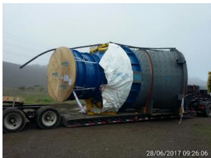
Llegada de la Turbina U2 del sector norte de la Casa de Máquinas. Pesa 57 Ton.
