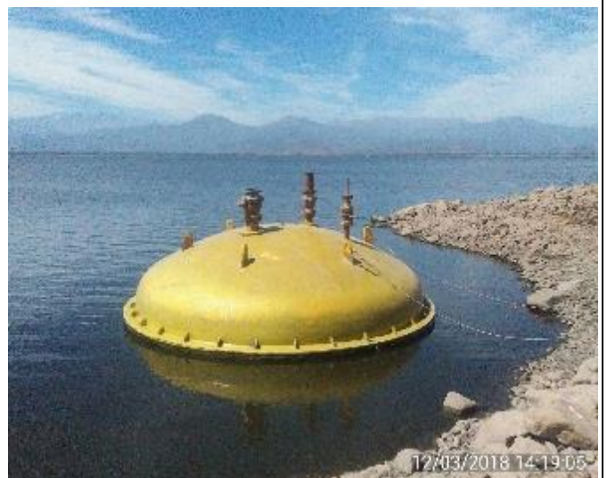
Tapón Toriesférico después de ser removido de la Toma de Captación, amarrado a la orilla de la Playa del Embalse Convento Viejo.
