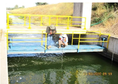
Canal Matriz Nilahue Tramo 1 en bocatoma Uva Blanca, inspección de aforo.
