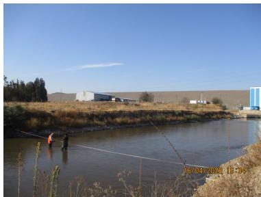
Inspección de aforos en estación Canal San Luis (aguas abajo de Central Hidroeléctrica)
