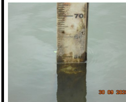
Estación de medición Tipo 1 Estero Chimbarongo bajo ECV fecha 30/09/2020. Altura a las 10:07 h Lm: 0,47 m Caudal según DGA a las 10:12h:
