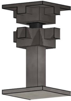
Sistema de aislación sísmica.
