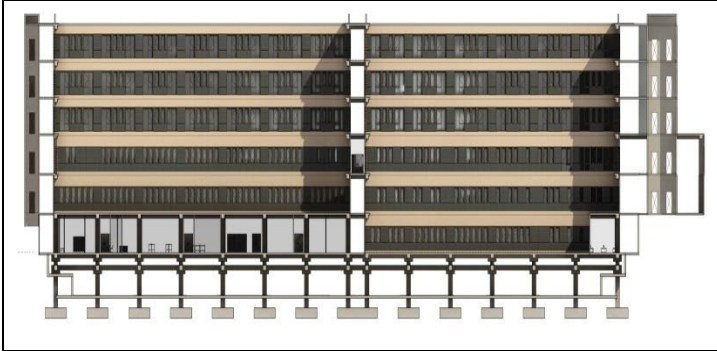
Corte transversal y aislación sísmica
