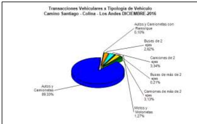
Gráfico 2: Distribución de Flujos de Diciembre 2016, por categoría de vehículo Fuente: Reporte SICE 29
