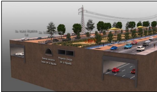
Fig. 2: perfil de solución soterrada bajo Avda. Centenario
