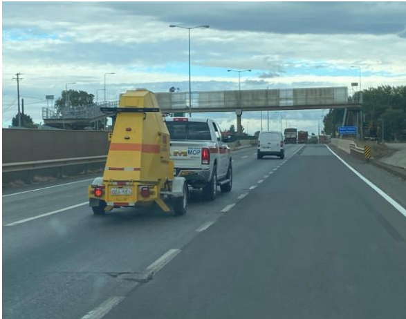
Deflectometría de Impacto, realizada por personal de vialidad,
