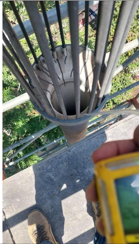
Medición de gases chimenea - Punto de Quiebre
