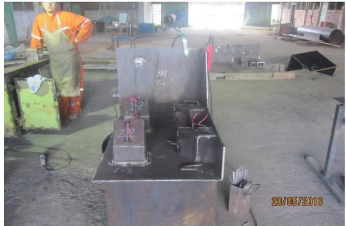
Pedazo del Moldaje de la parte superior aguas arriba, que será necesario soldar bajo el agua por los Buzos, a unos 27 metros de profundidad, para evitar filtraciones y darle mayor firmeza.
