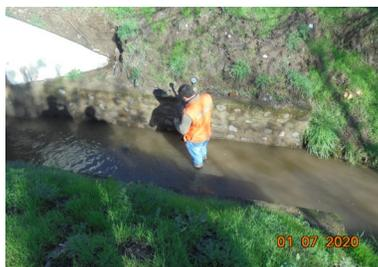
Inspección de aforos en estaciones de canales afluentes al Embalse, sector Quinta. (estación Tipo 2 Monterilla)
