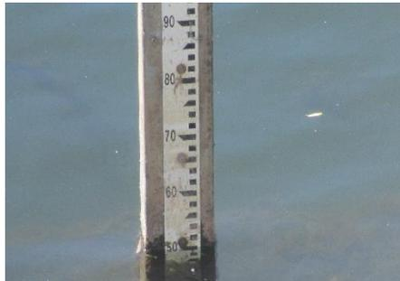
Fecha 01/12/2022, 12:42 h. Altura limnimétrica: 0,53 m. Caudal: 18,797 m<sup>3</sup>/s.
