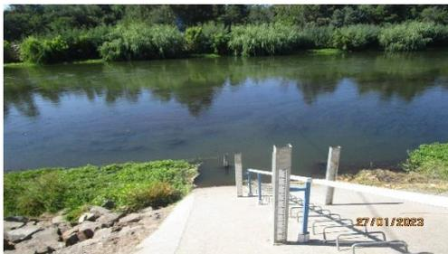
Fecha 27/01/2023, 11:12 h. Altura limnimétrica: 0,74 m. Caudal: 37,567 m<sup>3</sup>/s.
