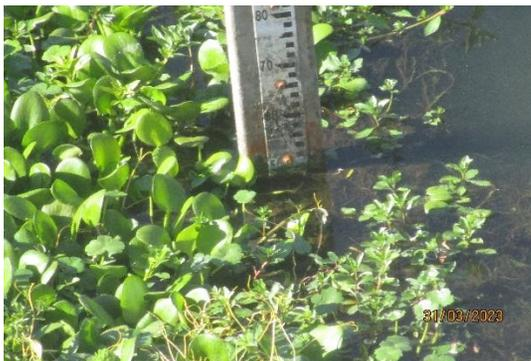
Fecha 31/03/2023, 10:15 h. Altura limnimétrica: 0,50 m. Caudal: 15,376 m<sup>3</sup>/s.
