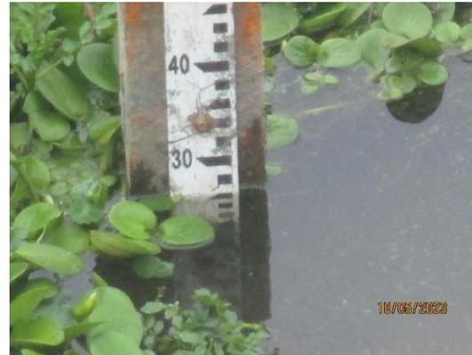
Fecha 18/05/2023, 10:25 h. Altura limnimétrica: 0,26 m. Caudal: 14,719 m<sup>3</sup>/s.
