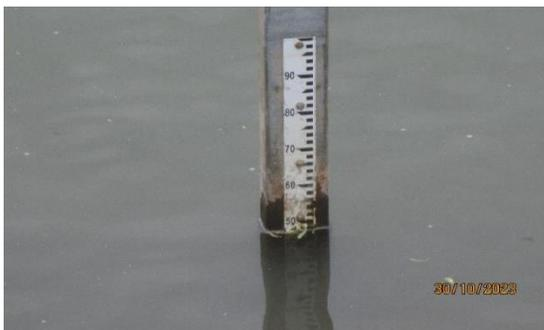
Fecha 30/10/2023, 10:40 h. Altura limnimétrica: 0,47 m. Caudal: 36,602 m<sup>3</sup>/s.
