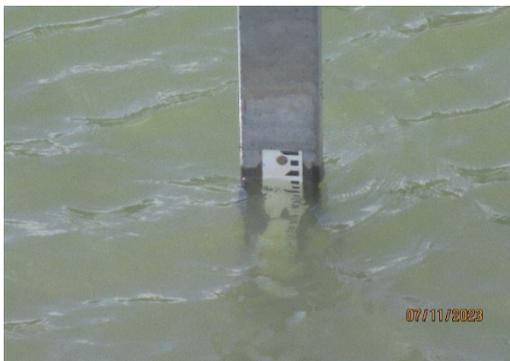
Fecha 07/11/2023, 10:20 h. Altura limnimétrica: 0,94 m. Caudal: 36,602 m<sup>3</sup>/s.
