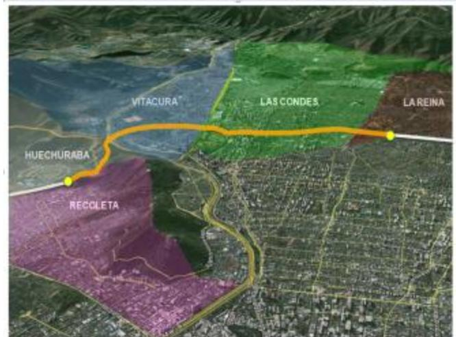
Su diseño contempla la ejecución de 2 calzadas expresas de tres pistas por sentido en casi toda su extensión. En particular, desde el sector de El Salto hasta el sur del Puente Centenario, se proyecta la ejecución de un Viaducto de 1.290 m y un túnel de tres pistas bajo el Cerro San Cristóbal y bajo el río Mapocho, diseñado para el tránsito en sentido poniente - oriente.
