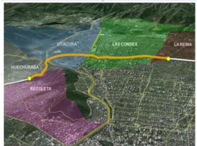
Su diseño contempla la ejecución de 2 calzadas expresas de tres pistas por sentido en casi toda su extensión. En particular, desde el sector de El Salto hasta el sur del Puente Centenario, se proyecta la ejecución de un Viaducto de 1.290 m y un túnel de tres pistas diseñado para el tránsito del poniente al oriente.
