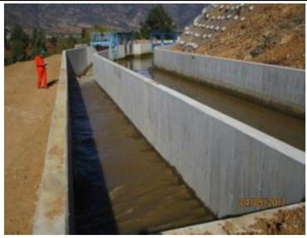
Prueba de agua disipadores de energía, bajada rebalse en Canal Norte Unificado (C.N.U.)
