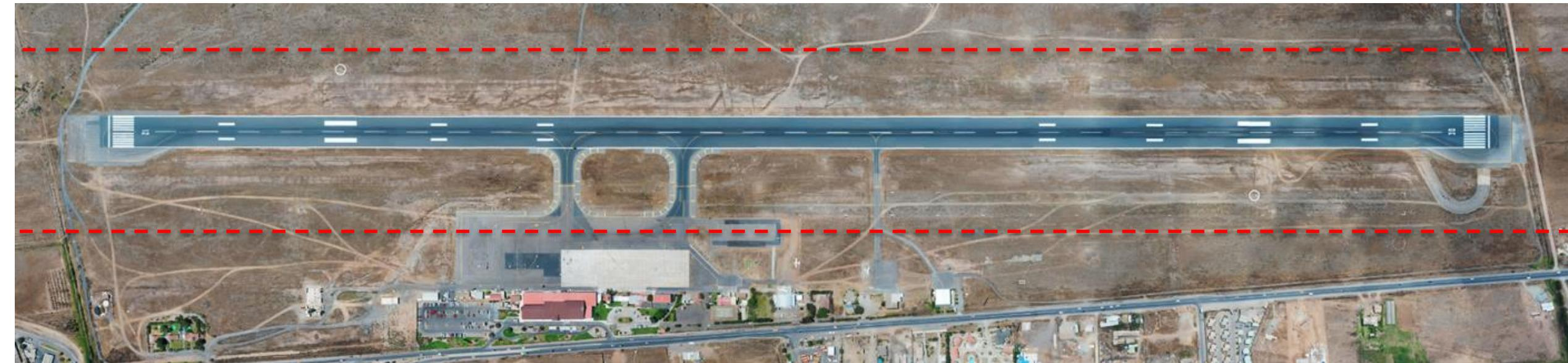
SE OBSERVAN BRECHAS DE NORMALIZACIÓN: FALTA DE MÁRGENES EN PISTA, NECESIDAD DE NORMALIZACIÓN DEL CABLEADO DE PISTA, NECESIDAD DE PLATAFORMAS DE VIRAJE EN PISTA.
