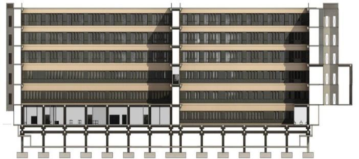
Corte transversal y aislación sísmica
