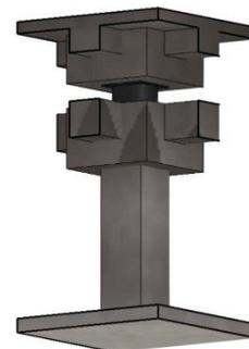
Sistema de aislación sísmica.
