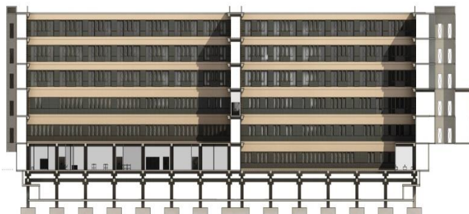
Corte transversal y aislación sísmica
