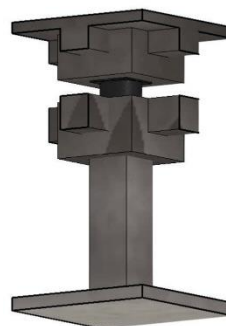
Sistema de aislación sísmica.
