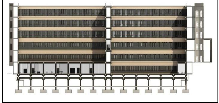
Corte transversal y aislación sísmica
