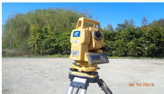
Chequeo de Calibración Equipos topografía.
