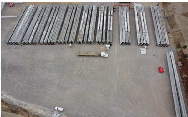
Vigas Pretensadas L>40m
