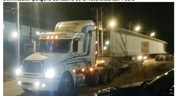
Pruera de Transporte de Vigas
