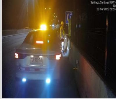
Vehículo de Asesoría equipado con baliza, luces estroboscópicas y cinta reflectante.
