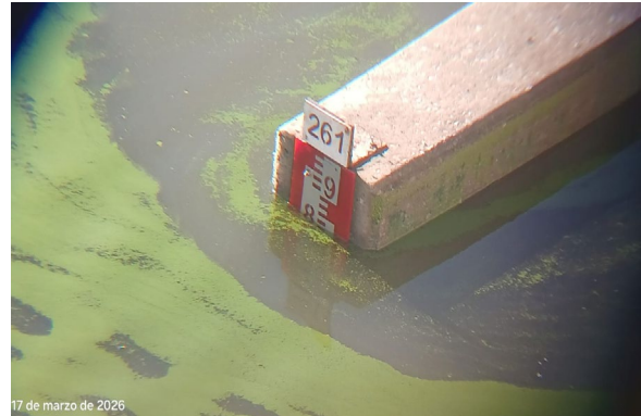
Imagen N°6. Cota 260,820 m.s.n.m. con un volumen de 82.528.919 m3 (10:20 horas) al 17.03.2026, presa auxiliar.
