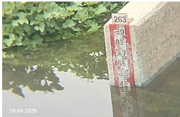
Imagen N°6. Regleta Presa Auxiliar del 29.04.2026 con una altura de 262,830 m.s.n.m. (10:30 horas), equivalente a un volumen total: 114.970.783 m 3
