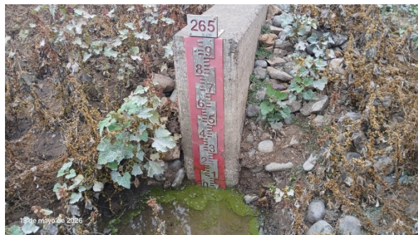
Imagen N°6. Regleta de la Presa Auxiliar con una altura de 264,020 m.s.n.m. equivalente a un volumen de 137.891.374 m3.
