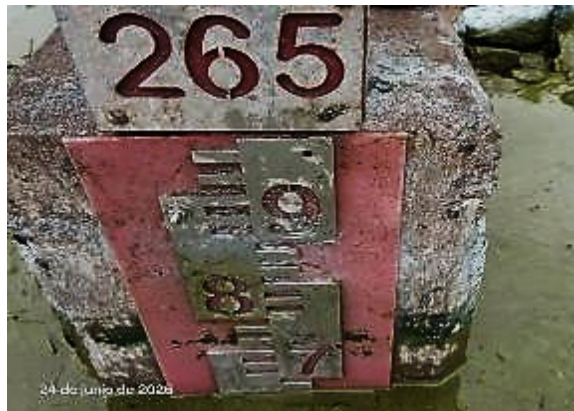
Imagen 6. Regleta de la Presa Auxiliar. Del 25.06.2026 con una cota de 264,640 m.s.n.m. y volumen de 151.001.492 m3.
