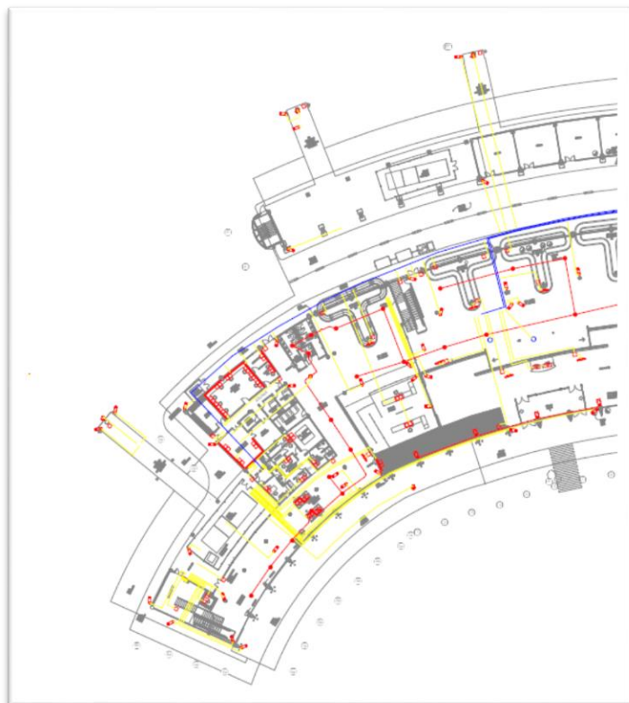
Layout: "Distribución Cámaras CCTV 1er. nivel Poniente"
